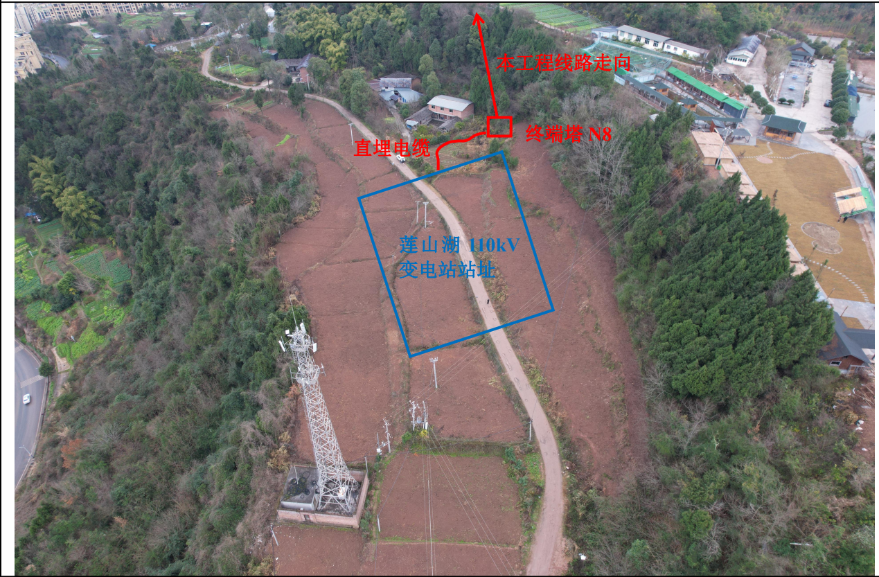
莲山湖 110kV 变电站站址出线情况
