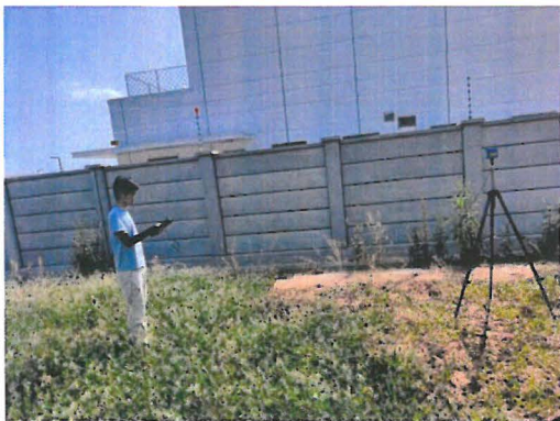
大堰 110kV 变电站 110kV 出线侧 电缆隧道上方电磁环境监测
