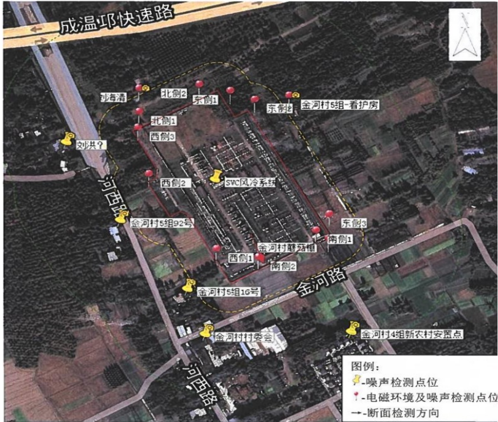
图 6-1 类比变电站的监测布点情况
