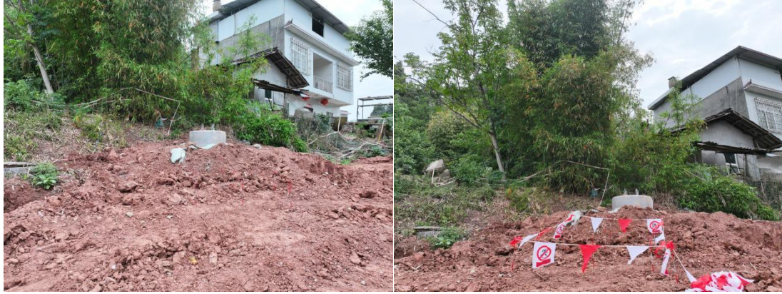
图 3-1、图 3-2 对塔基区布设测针，定期对测针进行监测
