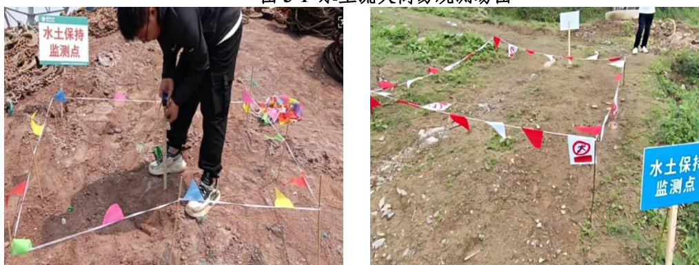
图 3-2 对塔基区布设测钎，定期对测钎进行监测
