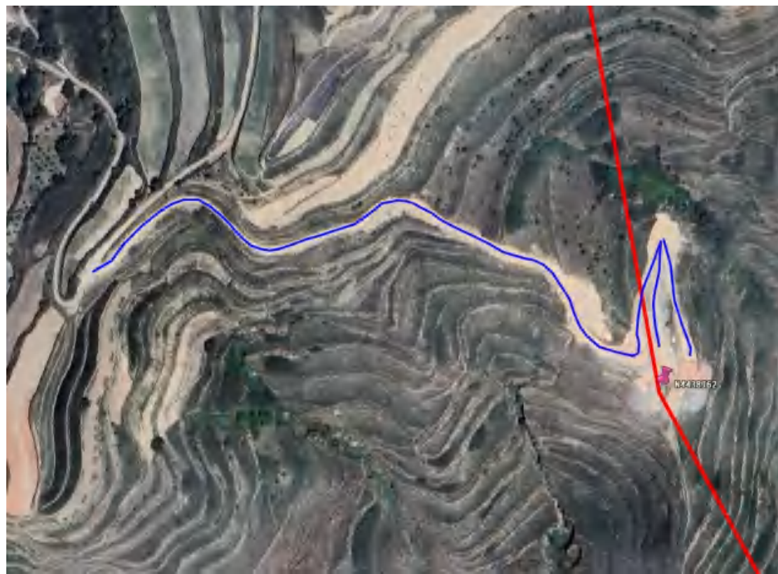
甘肃省通渭县，杆塔号：N4438 施工道路遥感正射影像解译，道路长度 660m，宽度 3~5m。
