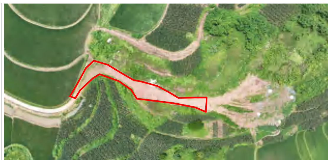
杆塔号：N6274 施工道路遥感影像解译（2024.6），道路长度 115m，宽度 3.6m。
