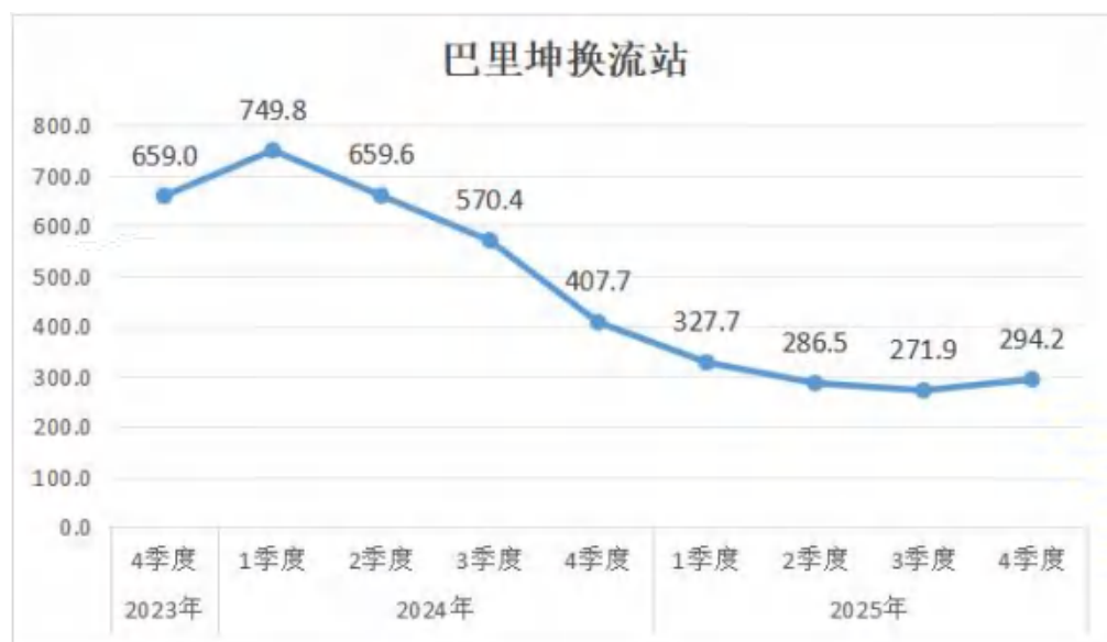
图 5.2-1 巴里坤换流站工程土壤流失量季度变化情况 单位: t
