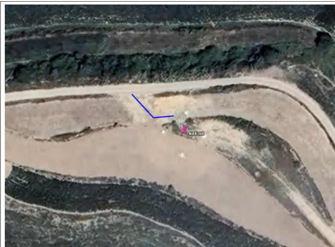
甘肃省通渭县，杆塔号：N4436 施工道路遥感正射影像解译，道路长度 17m，宽度 5m。
