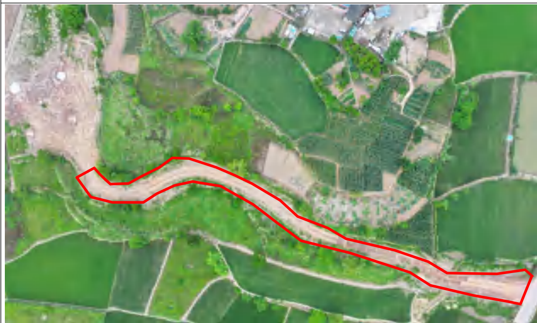
杆塔号：N6170 施工道路无人机正射影像解译（2024.6），道路长度 232m，宽度 3.2m。
