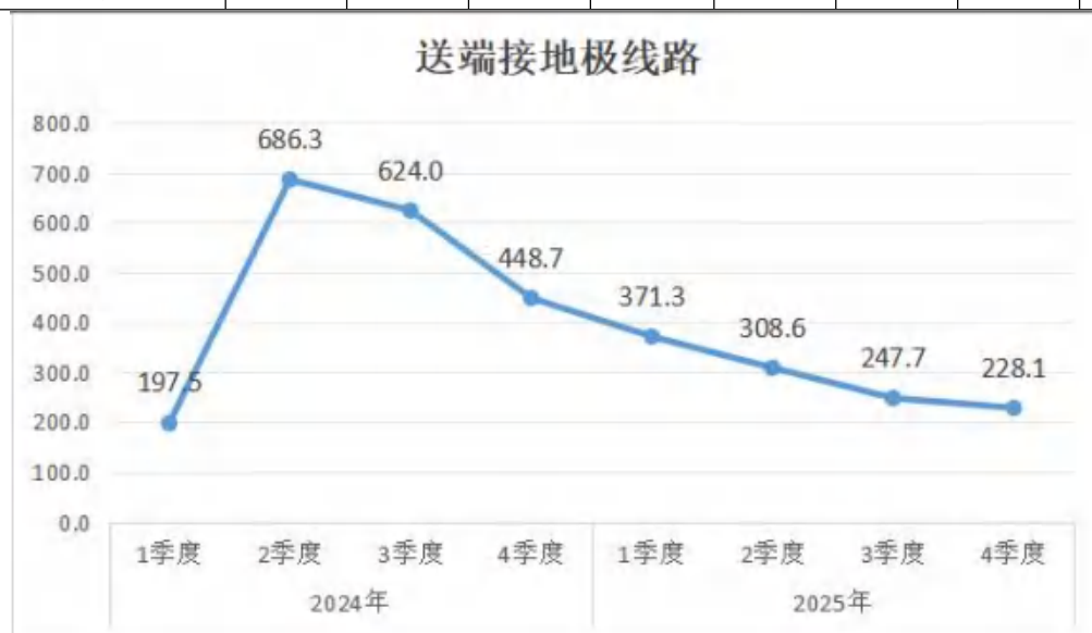
图 5.2-11 送端接地极线路工程土壤流失量变化情况 单位: t
