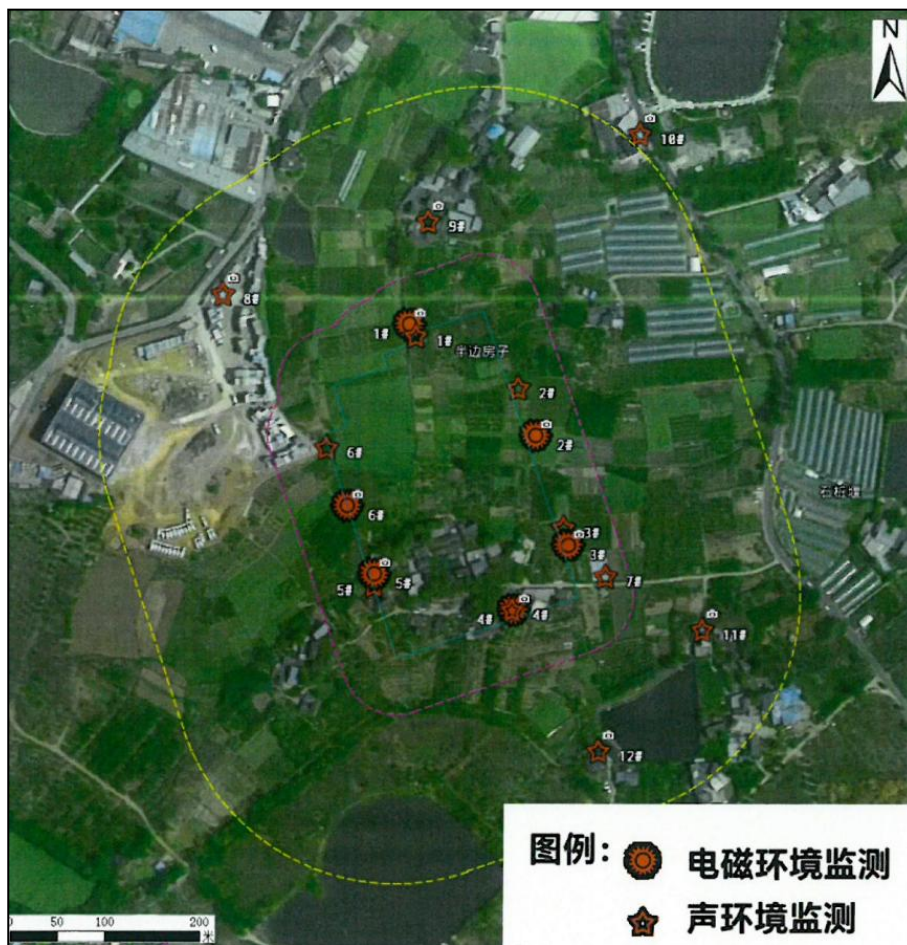
图 6-1 类比变电站的监测布点情况
