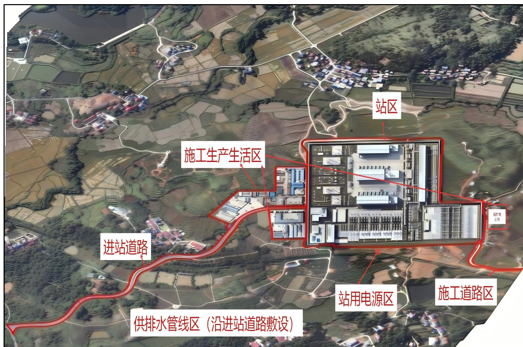
图 1.1-6 湖北站施工场地布置示意图
