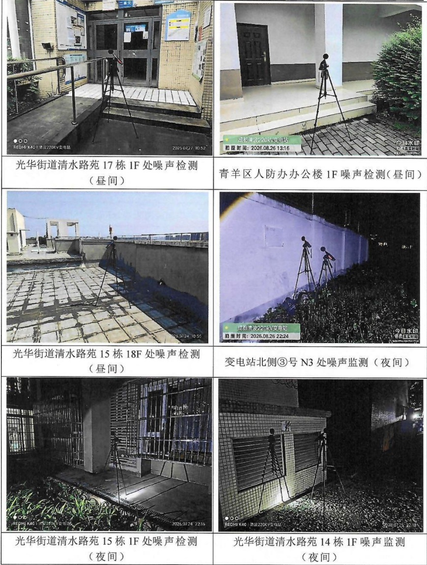
图 3 竣工环境保护验收检测照片（部分）
