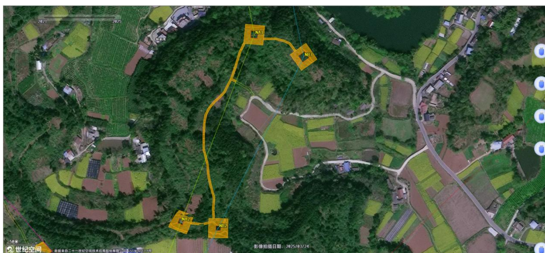
图 1.3-7 利用卫星遥感监测塔基区施工扰动情况
