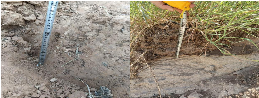
图 2.3-1 现场监测表土剥离范围及剥离厚度
